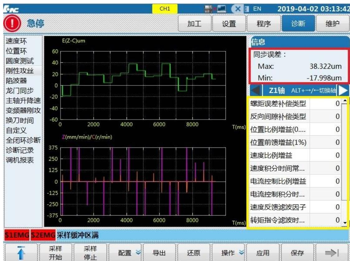
红色框标记部分为系统自动计算的同步误差，根据此同步误差对应调整 Z 轴伺服增益或主轴伺服增益，使的该值趋于极小值。即达到两轴插补的最佳状态。黄色框标记为攻丝轴伺服增益和加减速调整窗口。
